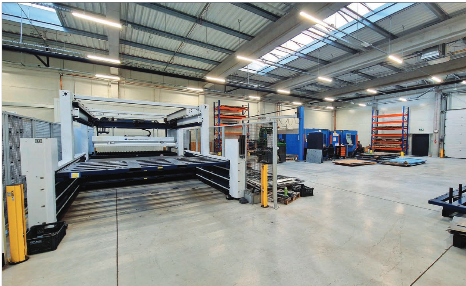
Hala produkcyjna – na zdjęciu automatyczny podajnik arkuszy blachy.
