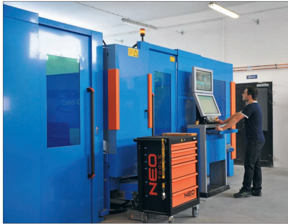
Operator obsługujący lasero-wykrawarkę, produkującą elementy kabin dźwigowych.
